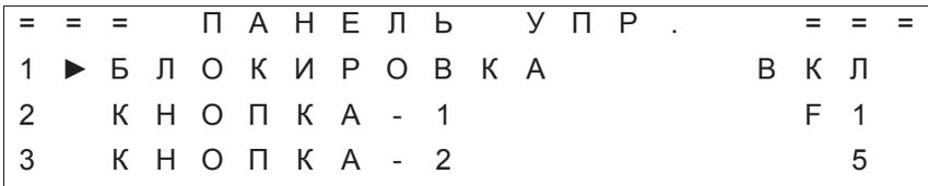
В строках меню «КНОПКА-1» и «КНОПКА-2» отображаются кнопки, используемые в комбинации для разблокирования клавиатуры. По умолчанию заданы кнопки «F1» и «5». Разблокирование клавиатуры выполняется одновременным нажатием кнопок и удержанием их до включения дисплея.
